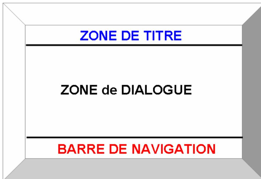
**Zone TITRE** : doit indiquer avec précision le mode de marche ou d'arrêt dans lequel se situe le système sous cet écran. Il peut aussi comporter, le N° de page ou d'écran (liaison avec la notice de maintenance), le rappel permanent du nom de la machine.
